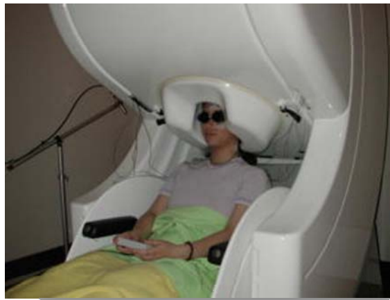
圖一、台北榮總內306頻道全頭型腦磁圖儀器(Vectorview, Elekta Neuromag, Helsinki, Finland)
