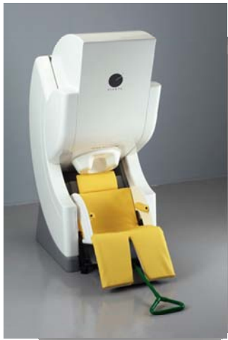
圖一、台北榮總內306頻道全頭型腦磁圖儀器(Vectorview, Elekta Neuromag, Helsinki, Finland)
